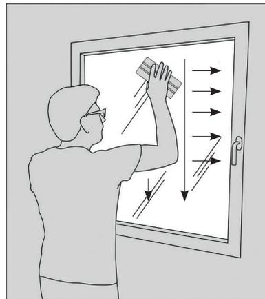
Squid® mit der Raker und mit starkem Druck (ca. 10 kg) auf dem Glas andrücken, ganze Fläche horizontal und vertikal bearbeiten, um den Kleber zu aktivieren. Die Kleberaktivierung ist Voraussetzung, um Blasenbildung zu vermeiden.
