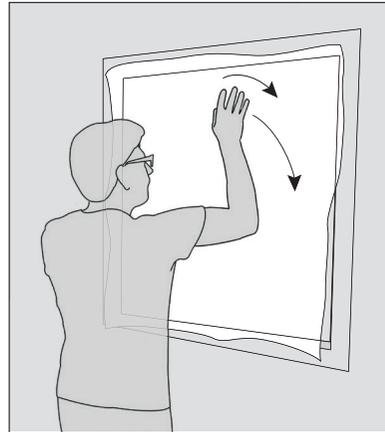
Squid® wieder leicht auf das Fenster anbringen, während das Gewebe mit der Hand oder einer Raker angestrichen wird. Falten oder Blasen nie mit Raker nach aussen drücken, dies kann zu dauerhaften Deformationen des Textils führen.
