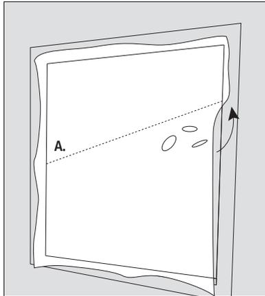
Sollte es zu Blasen oder Falten kommen, das Gewebe ohne Spannung nach oben ablösen, bis der Bereich der Blasen oder Falten gelöst ist (A).
