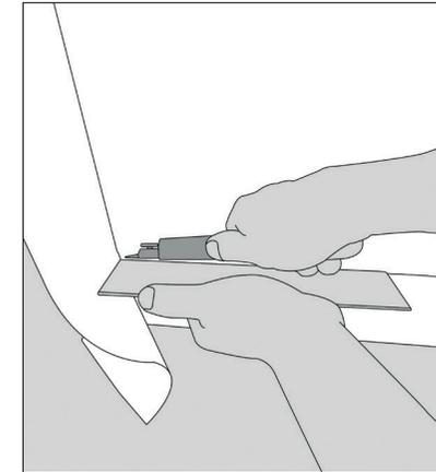
Platzieren Sie die Raker über der Silikonfuge, damit Sie das überstehende Gewebe sauber mit dem Messer (Cutter) wegschneiden können. Der Schnitt sollte durch einen gleichmässigen Druck und einem scharfen Winkel erfolgen.
