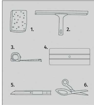
Hilfsmittel: Utensilien zur Fensterreinigung (1 und 2), Massband (3), Kunststoff-Rakel (4), Edelstahl-Cutter mit Abbrechklingen (5), Schere (6).
